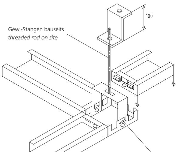
Nach dem Einhängen der Verbindungsprofile, Sicherung umbiegen
