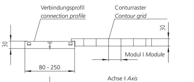
**Streckmetallkassette, glatt oder perforiert, ein- - bzw mehrteilig**
